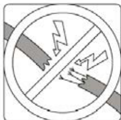
Auf beschädigte Drähte überprüfen
