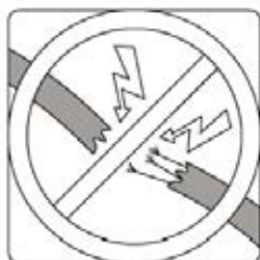
Controllo fili danneggiati
