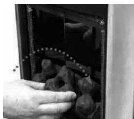
2. Chiudere completamente lo sportello dopo aver posizionato il carbone.
